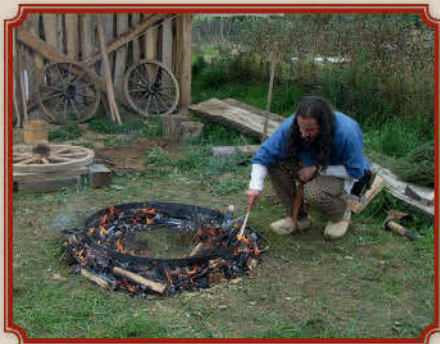
Der Radreifen wird im Feuer erwärmt.
