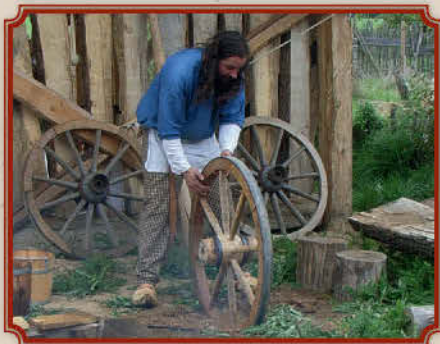
Anschließend wird das Rad im Trog stehend vollständig abgekühlt, damit sich der Radreifen fest an das Rad anlegt.
